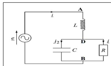
**Q18.** Exprimer  $L$  en fonction de  $R$ ,  $C$  et  $\omega$  pour que le dipôle AB soit équivalent à une résistance pure  $R_{\text{eq}}$ .
